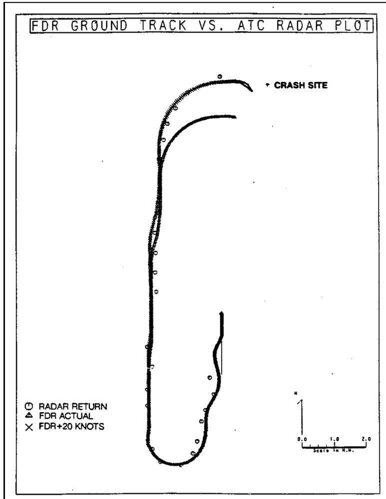
**FDR GROUND TRACK VS. ATC RADAR PLOT**
